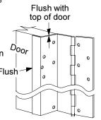
ALL HOLE LOCATIONS ON HINGE LEAF MUST BE FASTENED TO DOOR FOR PROPER OPERATION. FAILURE TO INSTALL ALL FASTENERS WILL VOID WARRANTY AND UL FIRE LABEL LISTINGS
